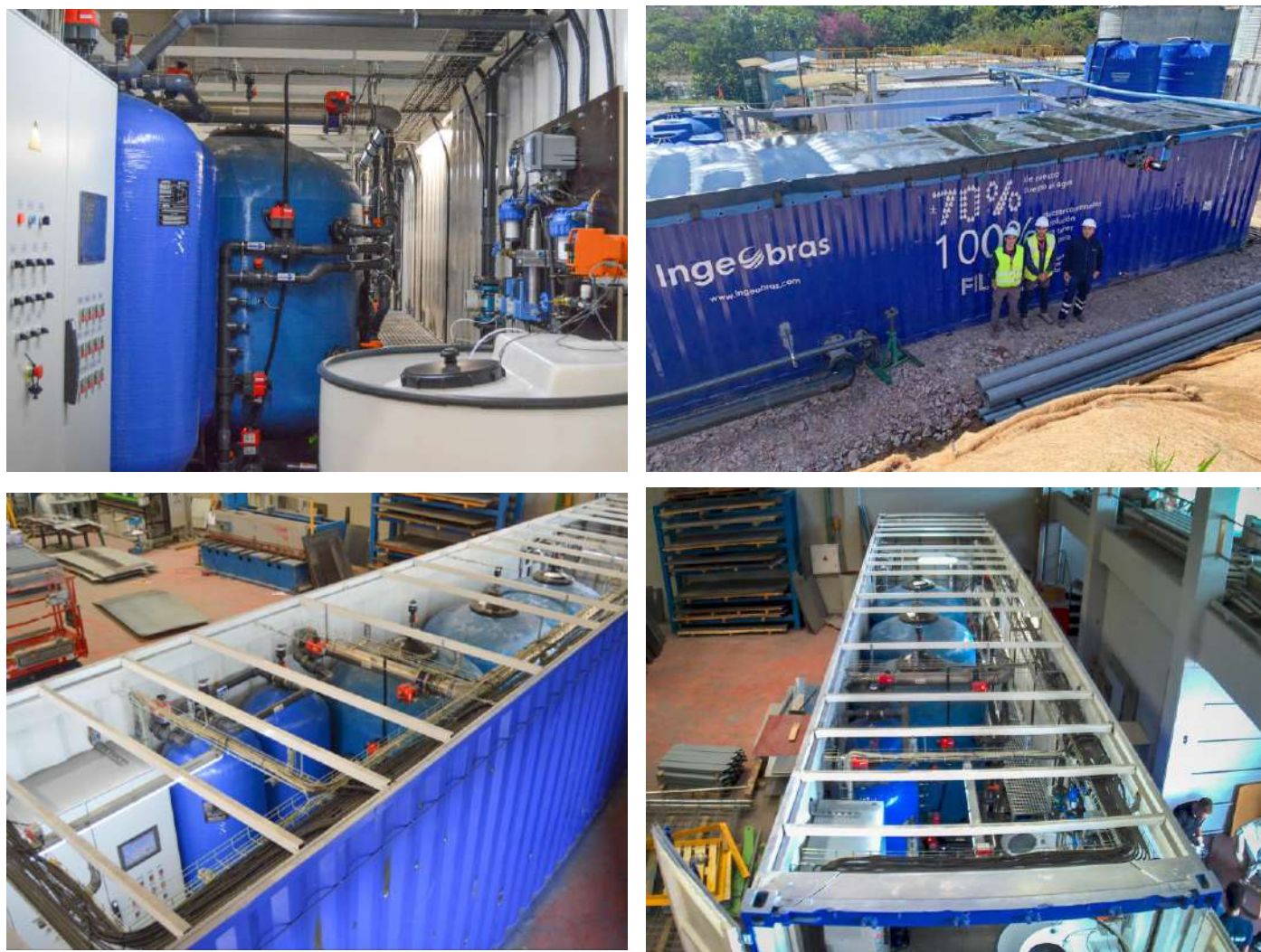
Figura 2: Imágenes interiores / exteriores de la planta BIOBOX de 7 m 3 /h
